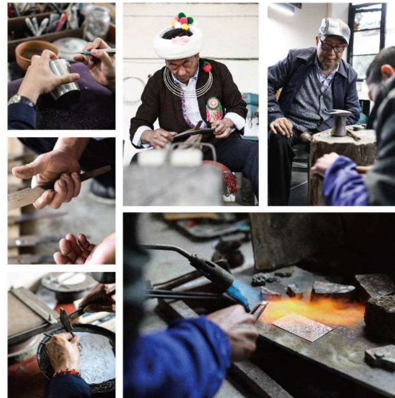
图1 为锡器制作技艺，传承人赖庆国手持电动雕刻笔进行锡器表面纹饰的微雕创作 图2 户撒刀技艺的传承人项老赛在打磨刀身 图3 金工传承人金永才在乌铜片上用錾子进行图案篆刻 图4 项老赛在制作刀鞘 图5 金永才在指导学徒对器物进行捂黑处理 图6 金工匠人将银块加热，烧至熔融，灌入开好槽的乌铜表面
